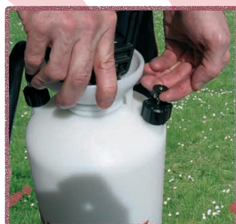
6 - Après emploi, retirez la pression en tirant sur la valve de surpression, purgez la lance et videz la poudreuse.
