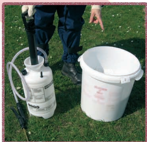
1 - Ouvrez la poudreuse P.P.S 50 et retirez la pompe.
