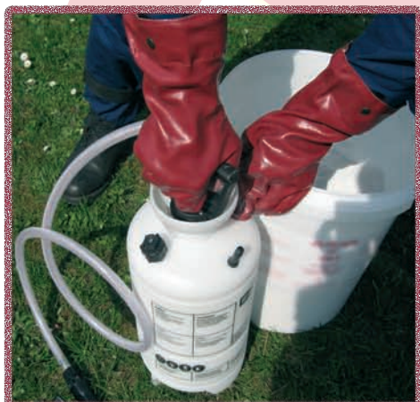
4 - Pompez plusieurs fois pour mettre sous pression.
